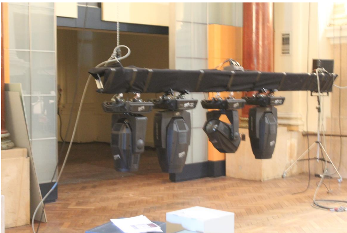
Figura 12 Moving Lights já instalados na treliça.
